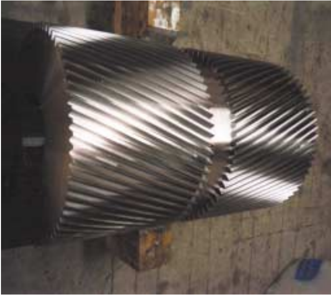
PIÑÓN SAE 4140 T. DIENTES RECTIFICADOS. PESO: 5180 KG.
